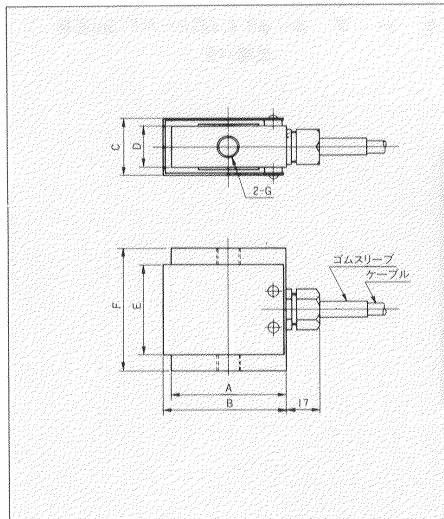
小型で、高精度な、引張型ロードセルです。3mV/Vの高出力が得られるうえ、小型の特長を活かして、取り付けもきわめて簡単です。
