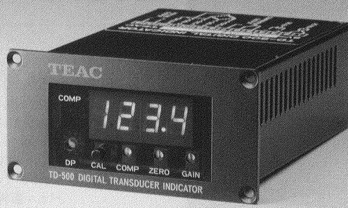
ひずみゲージ式トランスデューサと組み合わせて、荷重、圧力、加速度などの物理量を直読で指示および計測する、デジタル指示計です。DINサイズの小型ボディでローコストながら、トランスデューサ用指示計としての機能をすべて備えていますので、トランスデューサと電源の接続だけで、簡単に計測が開始できます。しかも、電源はAC/DC 2電源方式。そのコンパクトなボディを生かして、フィールドでの計測にも使用できます。
