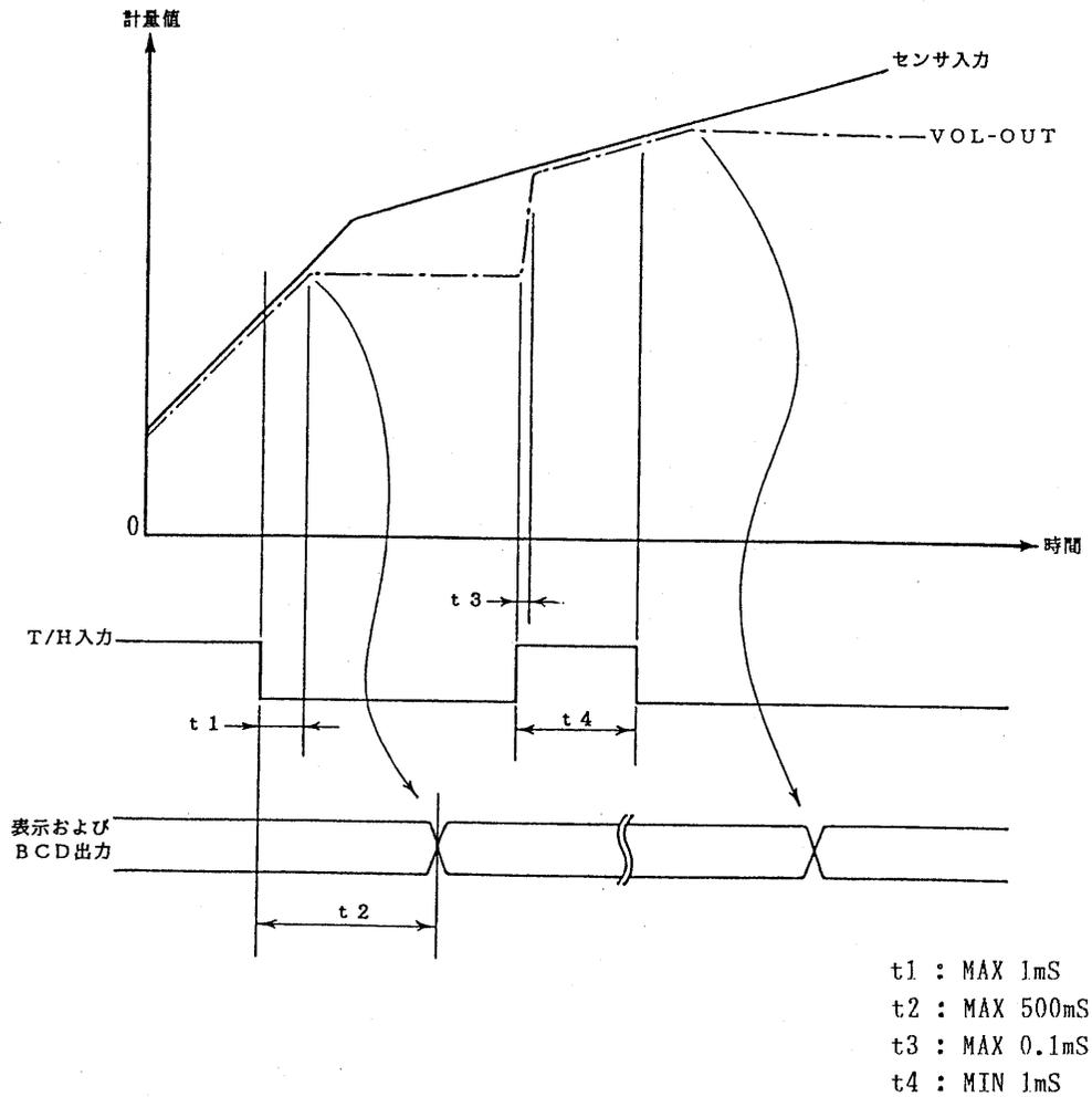
$t_1$  : T/H入力が短絡して (OFF→ON)から、センサーのアナログ値をホールドするまでの時間
