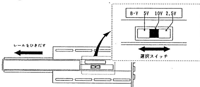
一般的には奨励印加電圧が10~12V以上のセンサーであれば10V、6~7Vなら5V、3Vのときは2.5Vを選択します。
