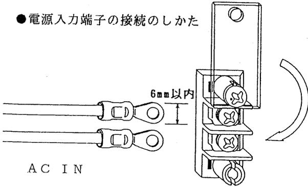
端子台への接続はケーブルの先端をばらさないように図のような圧着端子(M3)を付けてから接続してください。
