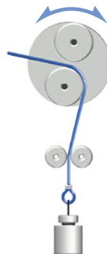
上図の様に芯線の移動が起らぬ様に固定し、左右に90度屈曲させ断線が起きない事を確認します。
