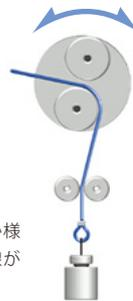
右図の様に芯線の移動が起こらない様に固定し、左右に90度屈曲させ断線が起きない事を確認します。
