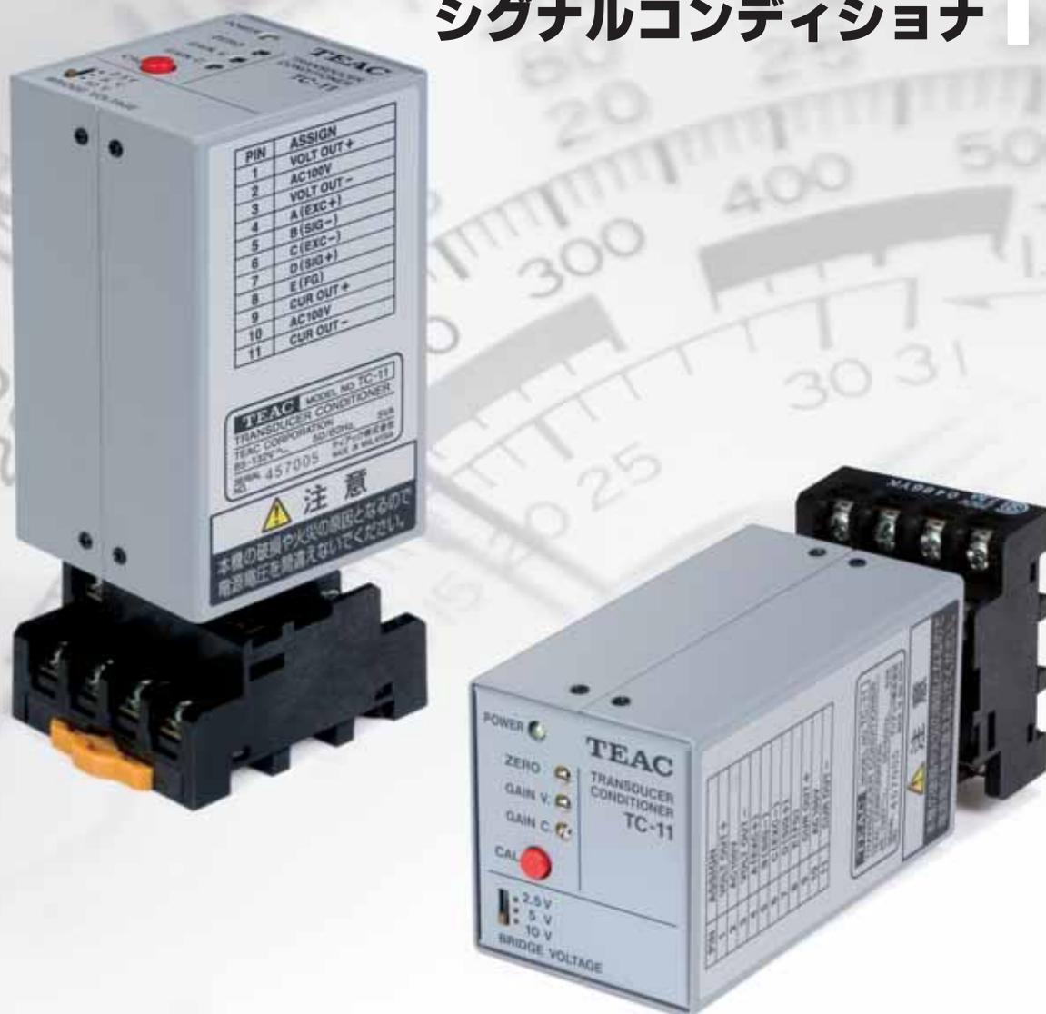
TC-11は、手のひらサイズ、プラグインタイプのひずみゲージ式トランスデューサ用シグナルコンディショナです。トランスデューサを用いた計装に必要なブリッジ電圧/ゼロ調整回路/ゲイン調整回路/校正回路および増幅回路を備えており、トランスデューサからの微小な信号を制御に適した電圧・電流として出力します。
