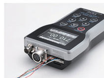
端子台入力 (バラ線での接続時)
