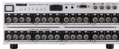
写真は32chモデル インテグレートッド ロガー LX-1000
