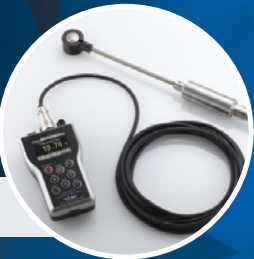
溶接時の加圧力を計測
