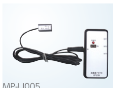
MP-U005 3軸加速度センサユニット (16G)
