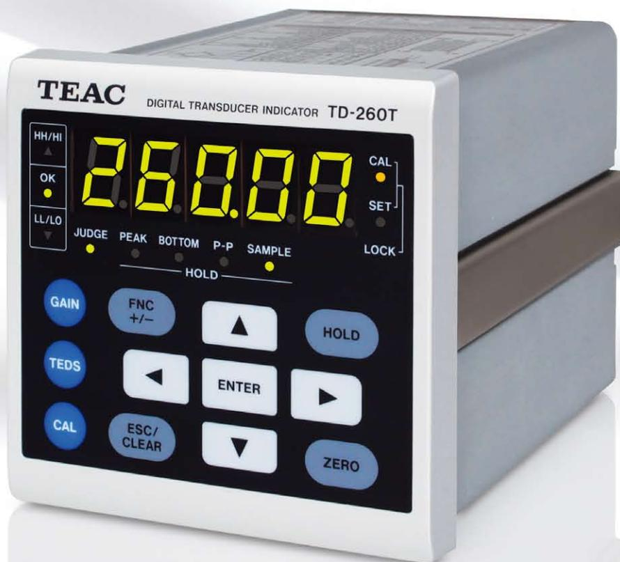
TD-260Tは、ひずみゲージ式トランスデューサー用デジタル指示計で、99999のプラス側フル5桁表示に対応、各種比較機能、ホールド機能をもつ小型計装用指示計です。
