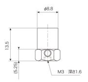
型式 701 感度(mV/m/s2)  $0.3 \pm 20\%$ 横感度(max) 5%以下 基底ノイズ(max) 30 μ Vrms以下 温度補償範囲 -20°C $\sim$ 110°C 周波数応答(±3dB) 3Hz∼30,000Hz 共振周波数 約60kHz
