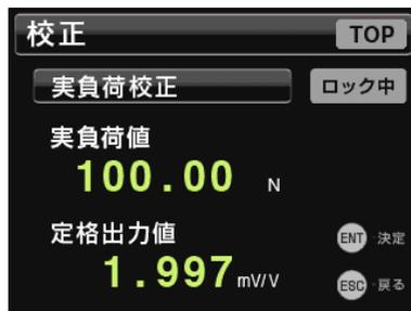
負荷校正結果を確認し、問題がなければ、ENT ボタンを押して負荷校正結果を確定して次の手順に進んでください。
