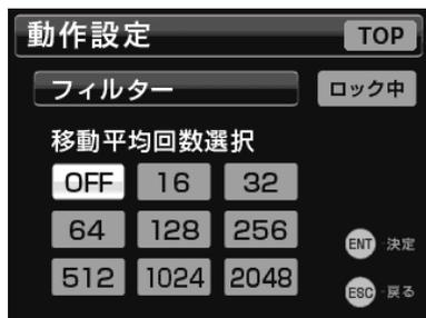
◀、▶ ボタンで選択位置を移動させ、ENT ボタンを押して確定します。選択項目が複数行ある場合は、選択位置を右端まで移動してさらに ▶ ボタンを押すと、次の行の左端に移動します。
