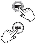
指示値リストを表示をしているときに、REC ボタンと ESC ボタンを同時に長押しすると、直近に記録されたデータを一つ削除できます。データを削除するその他の方法は、61 ページの「11-5. 記録データ消去」を参照してください。
