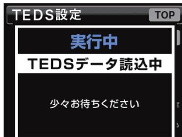
TEDS メモリーの復元データの読み込みが終了すると定格出力 (mV/V) と定格容量を表示しますので値を確認します。
