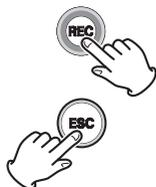
グラフリストを表示をしているときに、REC ボタンと ESC ボタンを同時に長押しすると、最新のデータを一つ削除できます。
