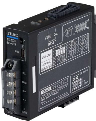
TD-SC1 は、ロードセルの微小な電気信号を、制御装置の仕様に合わせた出力に変換するシグナルコンディショナーです。本製品は主に、半導体製造装置、産業用ロボット、FA 装置等のロードセルの加圧力制御に用いられます。
