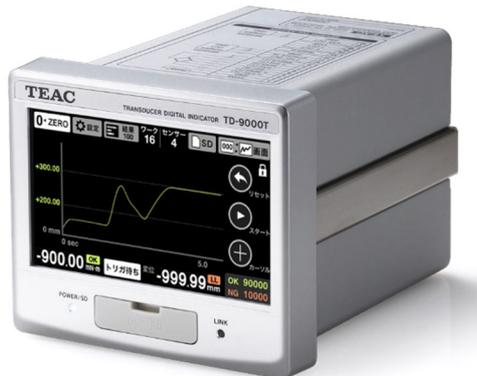
TD-9000Tは、荷重(ロードセル)とストローク(変位計)の2入力に対応した荷重管理用デジタル指示計です。24bit、25kHzの高速A/D変換、4.3型タッチパネルモニターを搭載し、直感的な操作性と優れた視認性を実現しています。
