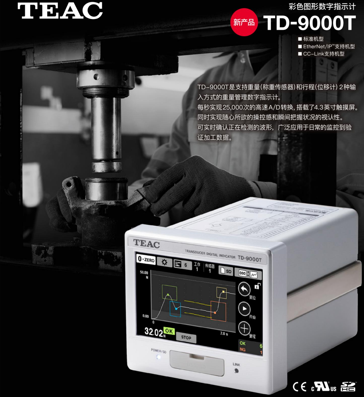
TD-9000T是支持重量(称重传感器)和行程(位移计) 2种输入方式的重量管理数字指示计。每秒实现25,000次的高速A/D转换, 搭载了4.3英寸触摸屏。同时实现随心所欲的操控感和瞬间把握状况的视认性。可实时确认正在检测的波形, 广泛应用于日常的监控到验证加工数据。
